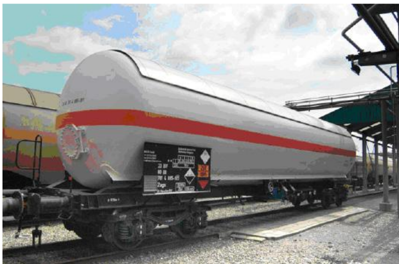
OBRÁZEK 8.4: ŽELEZNIČNÍ CISTERNA PRO AMONIAK S ORANŽOVÝM PÁSEM, TEPELNÝM ŠTÍTEM A IDENTIFIKAČNÍM ŠTÍTKEM [32].
