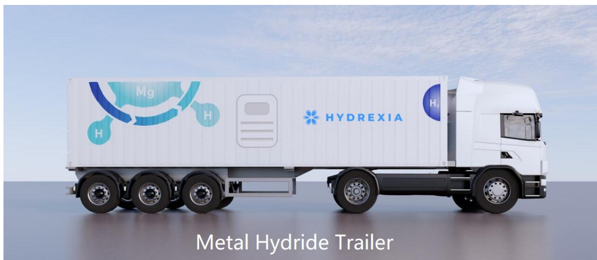
OBRAZEK 2.2: SILNIČNÍ PŘEPRAVA VODÍKU VE FORMĚ METALHYDRIDŮ – KONTEJNEROVÝ TRAILER SYSTÉMU HYDREXIA [9].
