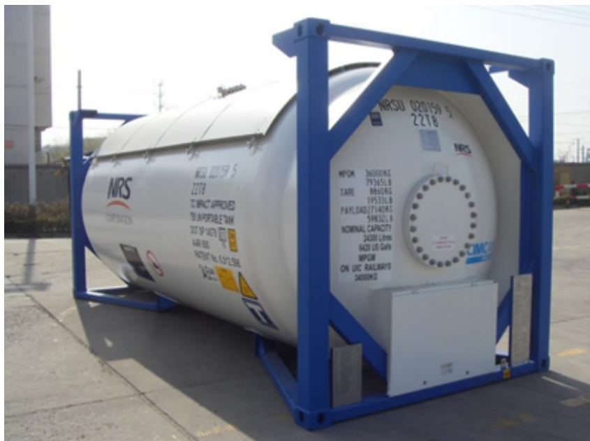
OBRÁZEK 9.7: PŘENOSNÉ NÁDRŽE PRO NÁMOŘNÍ PŘEPRAVU METHANOLU [58].
