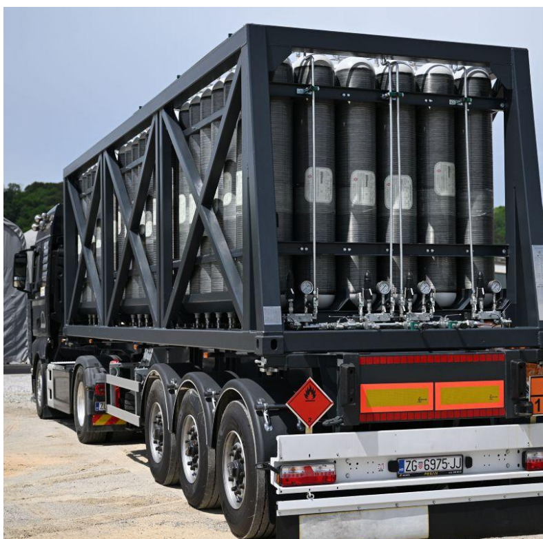
OBRÁZEK 3.2: MEGC KONTEJNER S TLAKOVÝMI LAHVEMI (OTEVŘENÝ DESIGN) [21].
