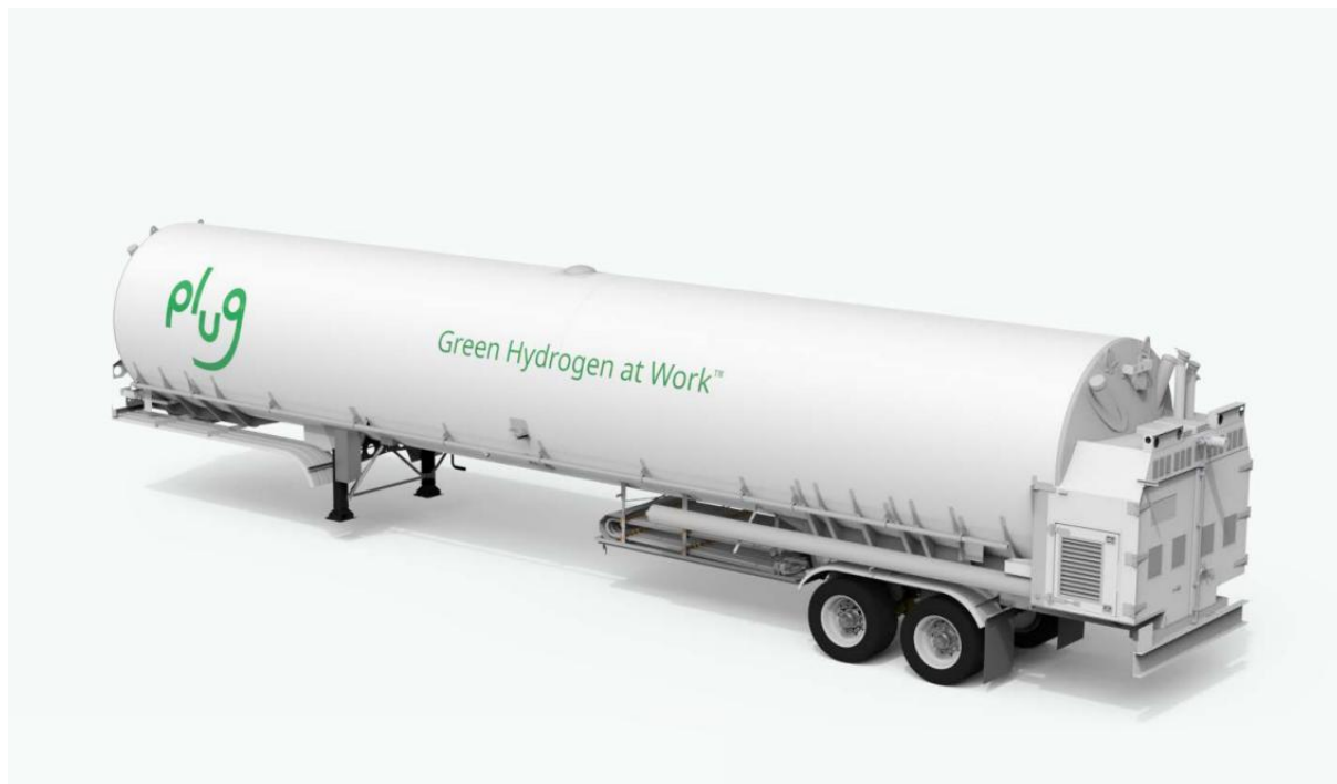
OBRÁZEK 6.1: TRAILER SPOLEČNOSTI PLUG POWER SCHOPNÝ PŘEPRAVIT AŽ 4,5 TUNY VODÍKU [12].
