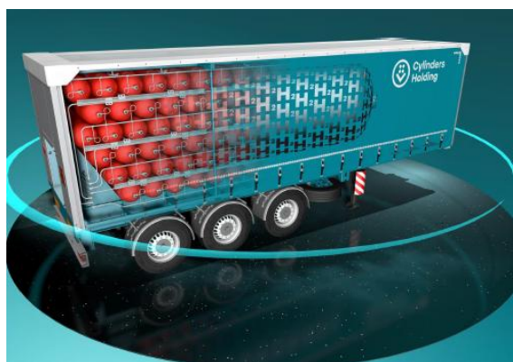
OBRÁZEK 5.3: VODÍKOVÝ TRAILER S MALÝMI LAHVEMI ORIENTO VANÝMI HORIZONTÁL NĚ [5].
