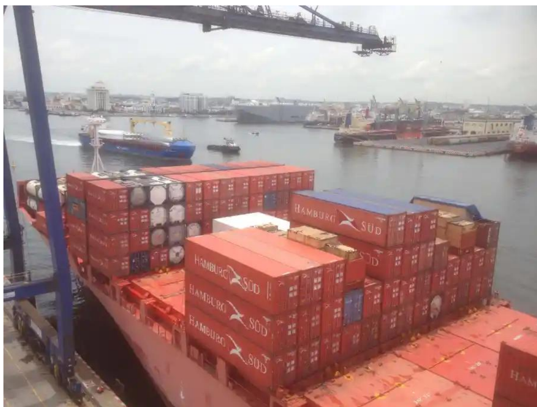
OBRAZEK 2.7: PALUBNÍ ULOŽENÍ KONTEJNERŮ NA KONTEJNEROVÉ LODI [86].
